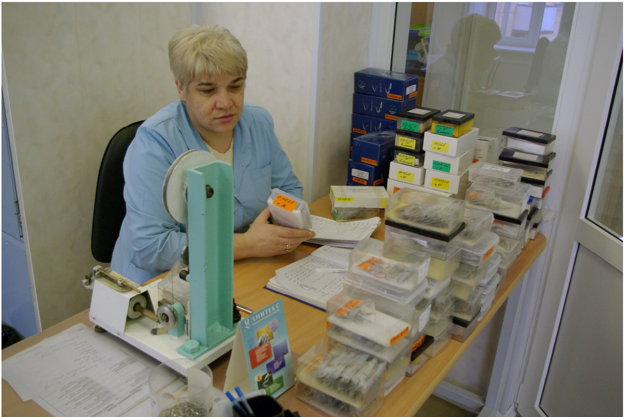
Проверка прочности соединения игольных наконечников с хирургической нитью
